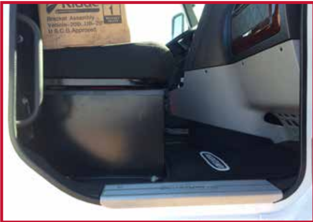
Figura 6 - Asiento del pasajero con caja de batería
