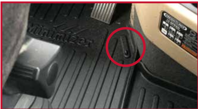
Figura 11 - Instalación del gancho del tapete del conductor
