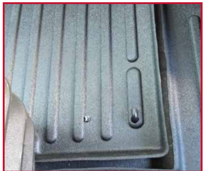
Figure 8 – Installation du crochet du tapis côté conducteur
