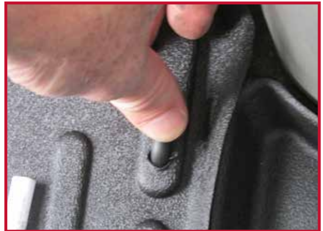
Figure 7 – Appliquer une pression sur le crochet
