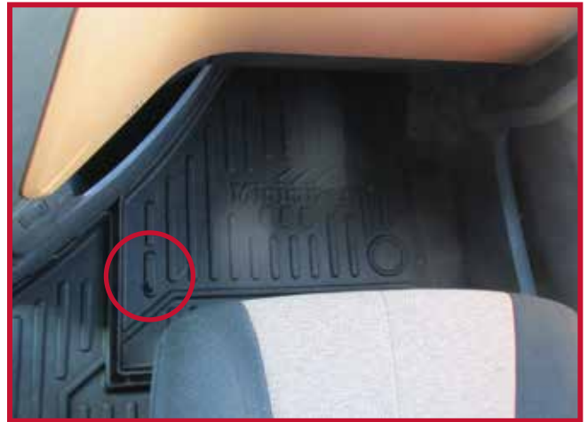
Figure 10 – Emplacement du crochet de retenue du tapis côté passager
