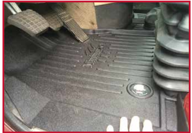
Figure 8 – Ajustement du tapis côté conducteur après le découpage
