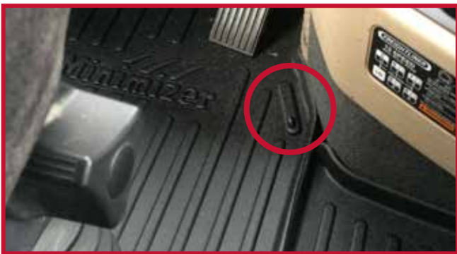
Figure 11 – Installation du crochet du tapis côté conducteur
