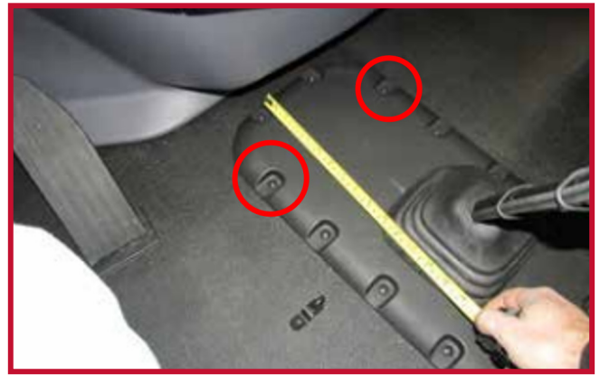
Figura 9 - Ubicación del gancho de retención
