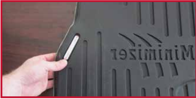
Figura 10 - Gancho insertado en el tapete del conductor
