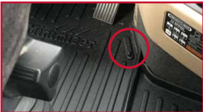
Figura 11 - Instalación del gancho del tapete del conductor
