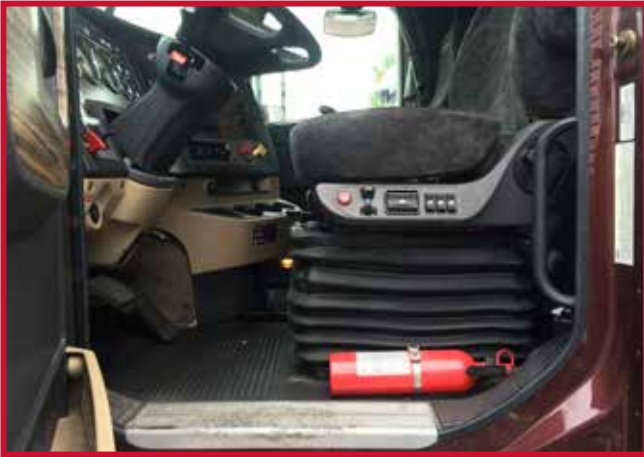
Figura 5 - Asiento del conductor con faldón de goma
