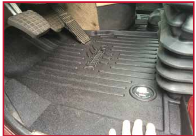
Figura 8 - Ajuste del tapete del conductor con el recorte
