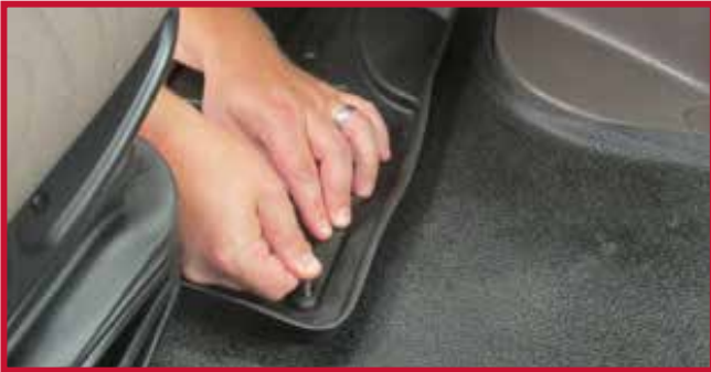
Figura 7 - Aplicar presión al gancho
