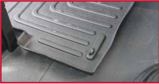
Figura 6 - Confirme la ubicación del conductor y el gancho
