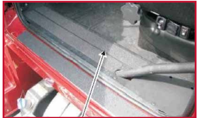
Figura 6 - Bandeja eléctrica del lado del conductor
