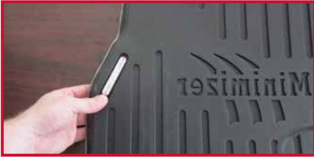
Figure 10 – Crochet inséré dans le tapis côté conducteur
