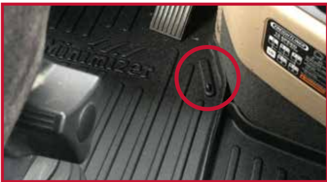
Figure 11 – Installation du crochet du tapis côté conducteur
