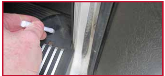
Figure 17 – Crochet de tapis côté passager installé
