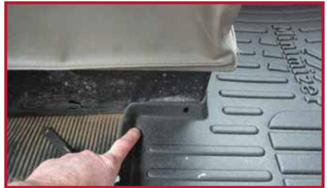
Figure 10 – Emplacement du crochet du tapis côté conducteur
