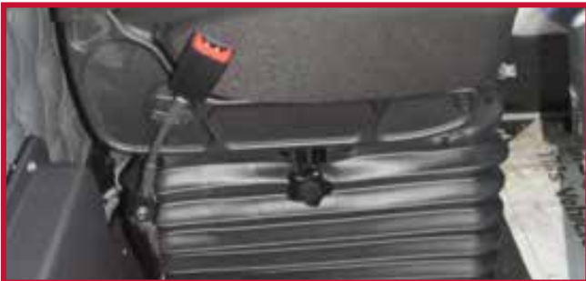
Figure 16 – Découpage à la main pour siège avec soufflet en caoutchouc
