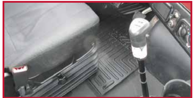
Figure 18 – Crochet du tapis côté conducteur en place
