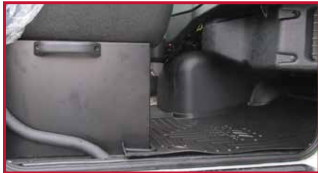
Figure 22 – Siège de passager à base fixe avec tapis découpé
