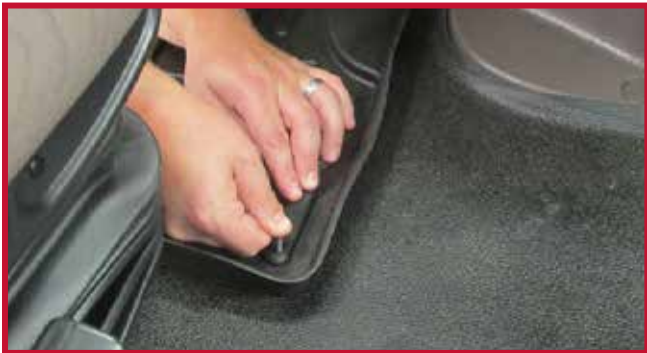
Figure 19 – Appliquer une pression sur le crochet
