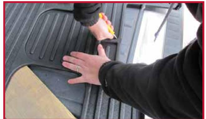
Nota: La figura 5 muestra el tapete central del kit #10002231 instalado en un camión con cabina diurna. Este tapete se recortó para que encajara alrededor del extintor existente y del kit de seguridad en carretera DOT.
