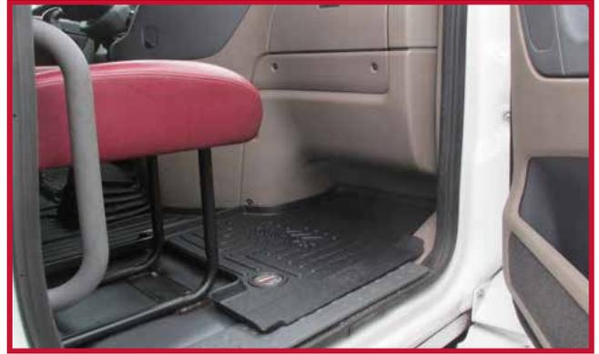
20. Tire del tapete del conductor hacia la parte delantera del camión para confirmar que el gancho está completamente encajado en el tapete y que el gancho está adherido al piso. Si el gancho no funciona correctamente o el tapete no puede instalarse de forma segura, no utilice un tapete Minimizer en el lado del conductor del vehículo.
