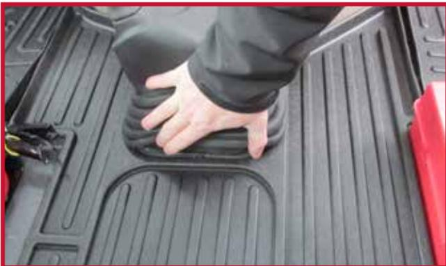
7. Coloque el tapete del conductor en la carretilla como se muestra en la figura 7.
