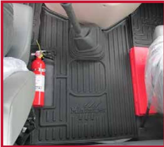
6. Enderece la funda de goma que rodea la palanca de cambios para que descansa suavemente sobre el tapete central, como se muestra en la figura 6.
