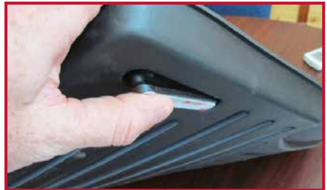
10. Una vez colocado el gancho, deje que el tapete del conductor y el gancho se apoyen en el piso, como se muestra en la figura 10.
