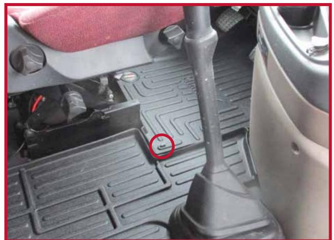
11. Marque con un dedo la posición aproximada en la que deberá fijarse el gancho al piso. Una vez localizada la posición, retire el tapete del conductor del camión.
