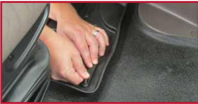
18. Para lograr una adhesión óptima, no perturbe el gancho durante un período de 20 minutos después de la instalación. La figura 12 muestra la instalación correcta del gancho.
