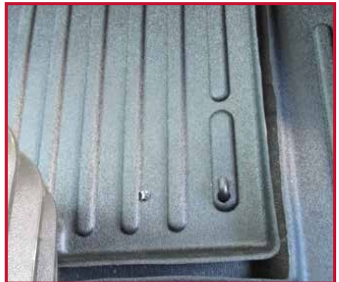
Figura 8 - Instalación del gancho del tapete del conductor
