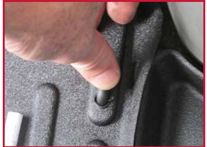
Figura 7 - Aplicar presión al gancho
