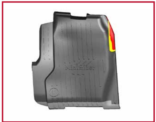
Figura 5 - Diagrama de recorte del tapete del conductor
