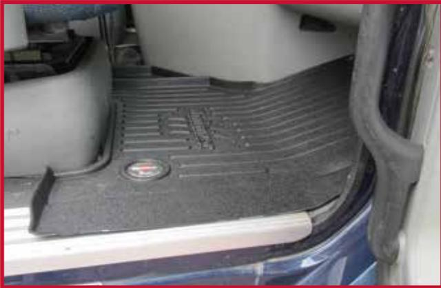
7. Pruebe al colocar el tapete del conductor en el camión. El tapete del conductor está diseñado para encajar debajo del pedal del acelerador. Para instalar el tapete del conductor, levante la parte del talón del pedal del acelerador y deslice la parte delantera del tapete por debajo del pedal. Compruebe que el tapete está empujado completamente hacia delante para que descansa contra la pared de fuego. La figura 6 muestra el tapete del conductor instalado en un camión con asiento OEM.
