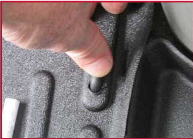
18. Para una óptima adherencia, no altere el gancho de retención durante un periodo de 20 minutos después de la instalación. La figura 11 muestra el tapete de conductor y el gancho correctamente instalados.
