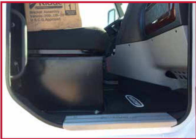
Figura 6 - Asiento del pasajero con caja de batería
