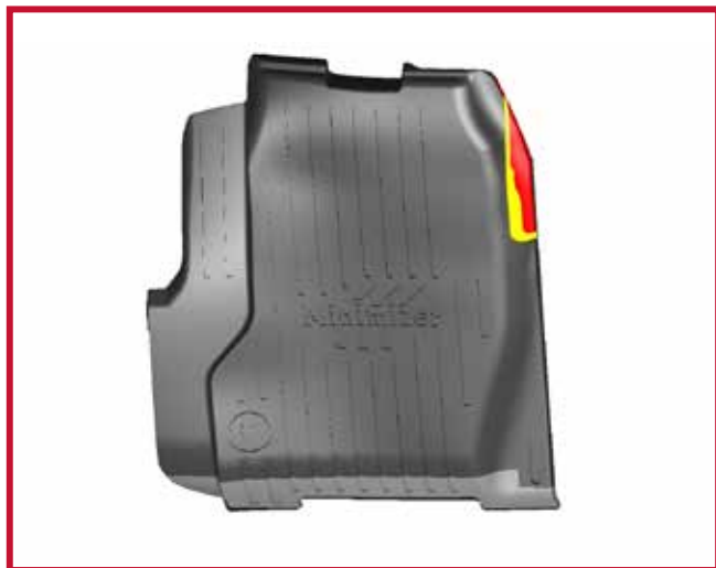
Figure 5 – Schéma de découpage du tapis côté conducteur
