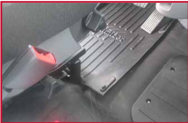
Figure 7 – Emplacement du crochet de retenue
