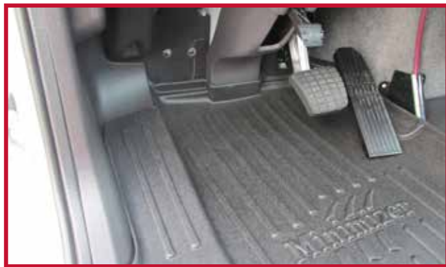
Figure 4 – Tapis côté conducteur en place
