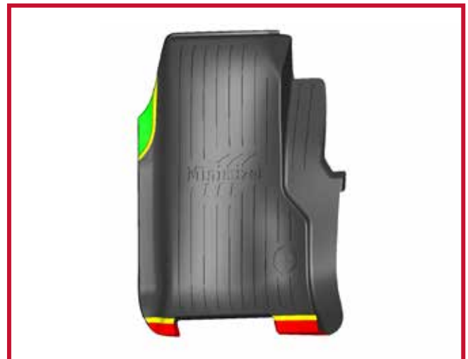
Figure 9 – Schéma de découpage du tapis côté passager
