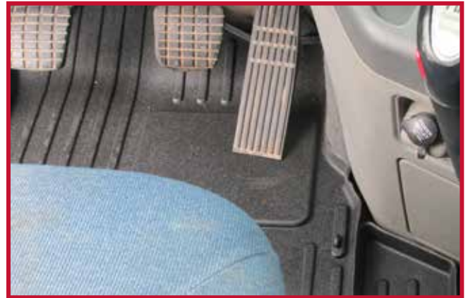
Figure 11 – Tapis côté conducteur et crochet correctement installés
