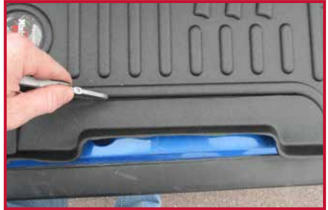
Figure 7 – Découpage du tapis côté conducteur pour installation avec un siège EzyRider ou un siège du marché de l'après-vente.
