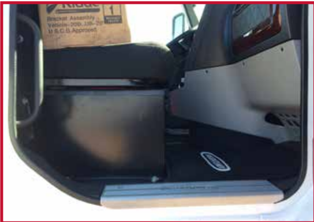
Figure 6 – Siège de passager avec rangement pour batterie sous le siège
