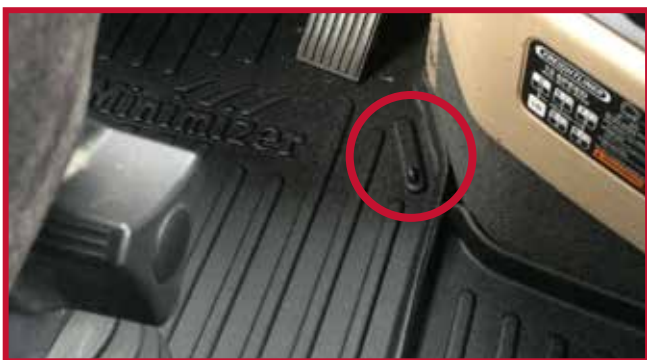
Figure 11 – Installation du crochet du tapis côté conducteur
