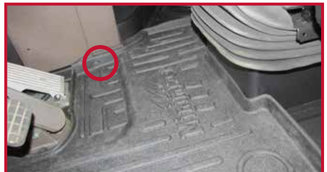
Figura 5 - Ubicación de la abertura para el gancho de retención
