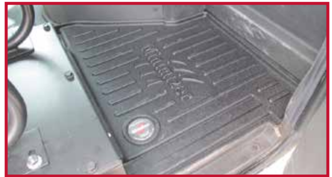
Figura 9 - Tapete de pasajeros instalado
