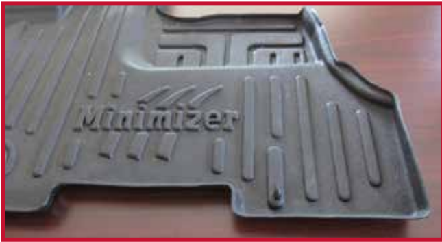
Figura 6 - Gancho de retención montado en el piso (sólo CAT CT)
