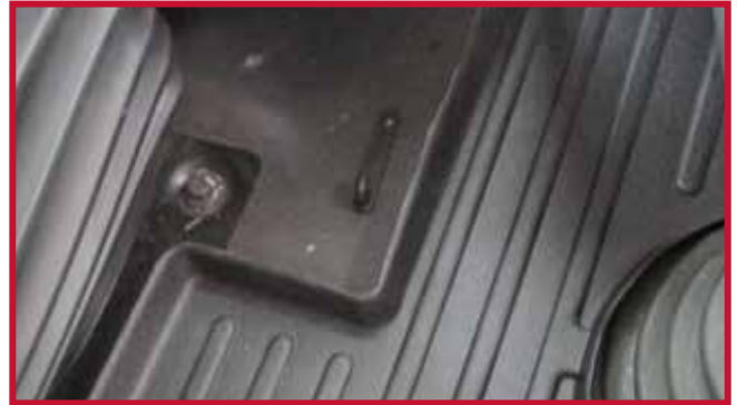
Figura 8 - Gancho de retención correctamente instalado
