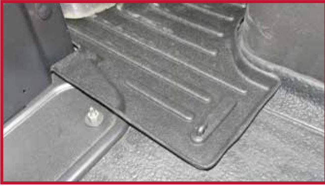
Figura 6 - Confirme la ubicación del conductor y el gancho
