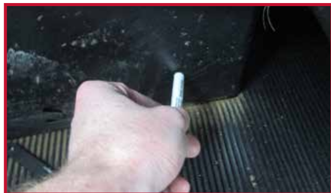
Figura 11 - Aplicar Primer 94 a la base del asiento
