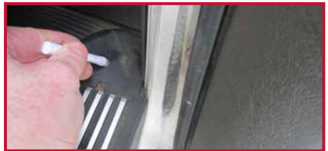
Figura 17 - Gancho del tapete del pasajero instalado
