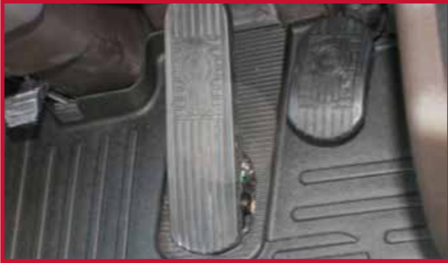
Figura 2 - Pedal de aceleración montado en el piso
