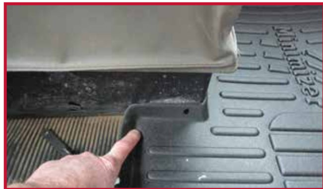
Figura 10 - Ubicación del gancho del tapete del conductor
