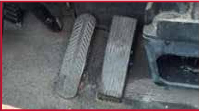
Figura 2 - Pedal de aceleración montado en el piso
