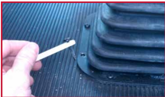
Figura 9 - Instalación del gancho en el tornillo existente
