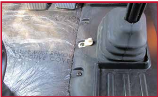
Figura 13 - Orientación correcta del gancho
