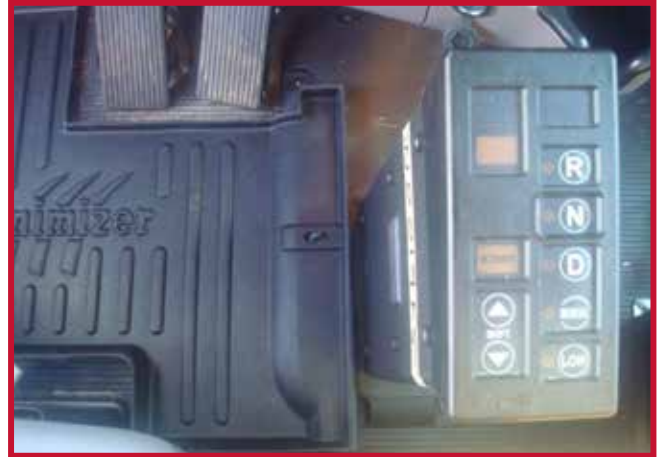
Figura 3 - Torre de control del Ultra Shift
