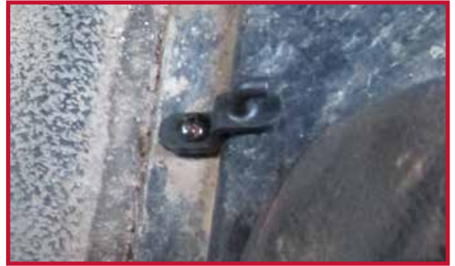
Figura 8 - Orientación correcta del gancho
