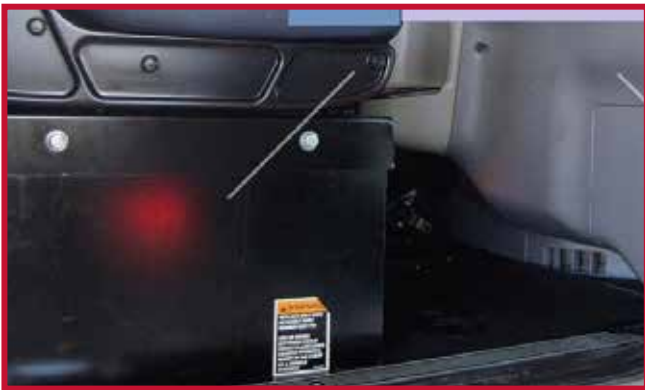
Figura 2 - Asiento del pasajero con almacenamiento de la batería
