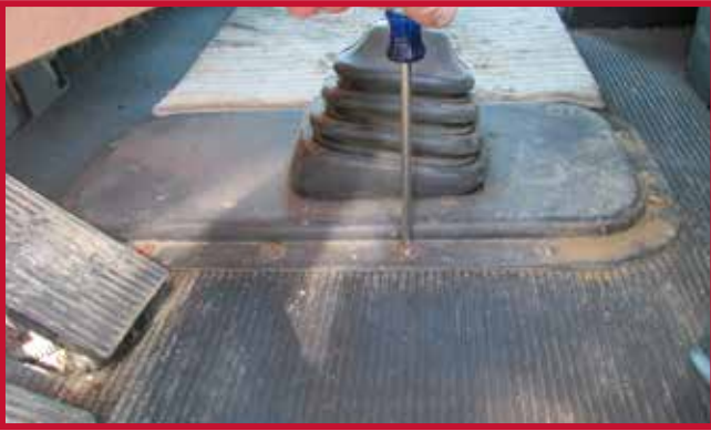
Figura 6 - Extracción del tornillo
