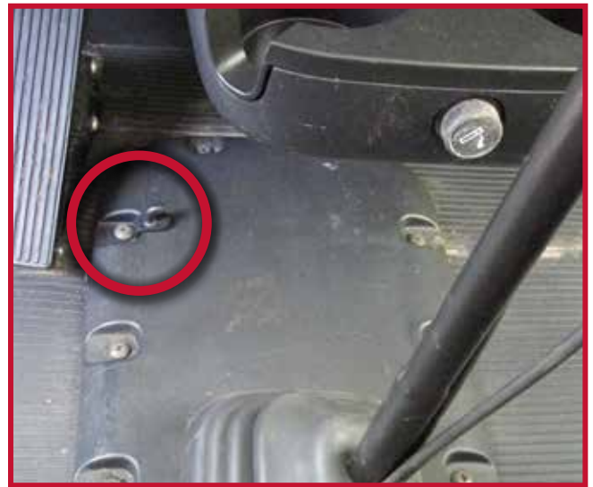
Figura 15 - Perno de montaje del pedal de freno
