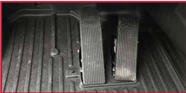
Figura 14 - Tapete del conductor instalado con gancho
