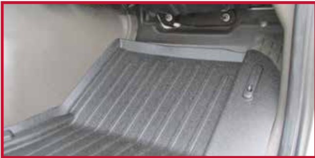
Figura 12 - Tapete y gancho del conductor correctamente instalados
