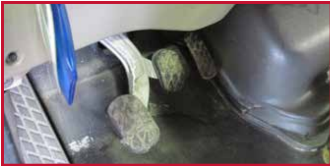
Figura 2 - Pedales de freno y acelerador suspendidos
