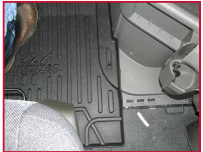
Figura 7 - Instalación del gancho del tapete del conductor
