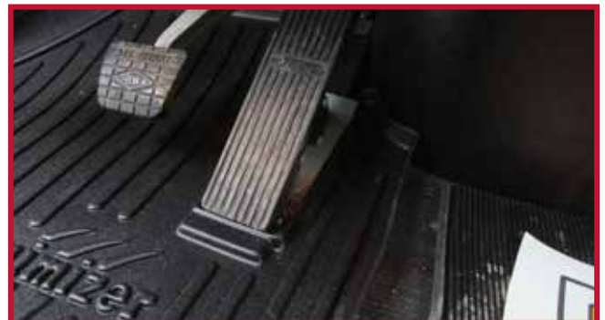
Figura 5 - 10002853 Instalación del tapete del conductor
