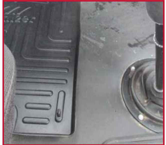
Figura 9 - Instalación del gancho del tapete del conductor
