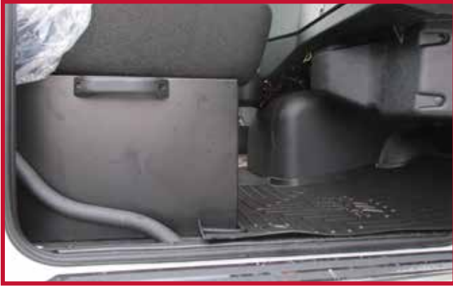
Figura 12 - Asiento del pasajero de base fija con tapete recortado
