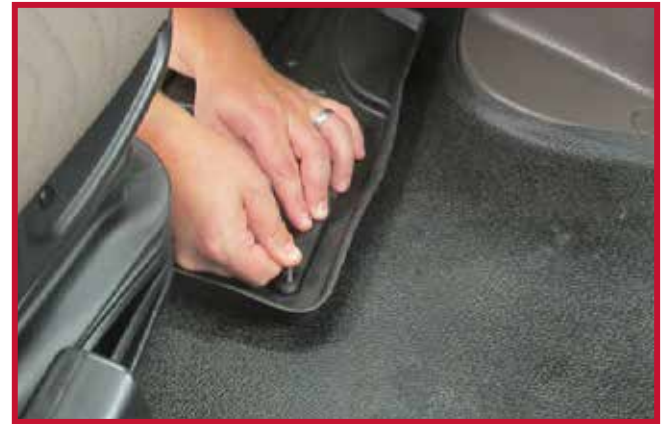
Figura 10 - Aplicar presión al gancho
