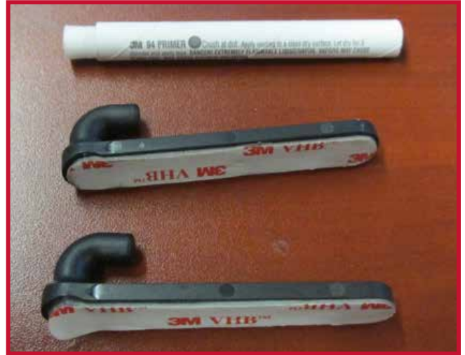
Figura 17 - Ganchos de retención y aplicación de Primer 94
