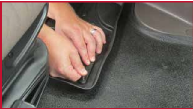
Figure 7 – Appliquer une pression sur le crochet
