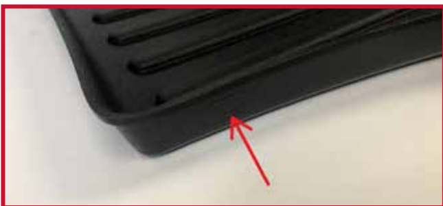
Figure 16 – Autre emplacement de trou de crochet de retenue
