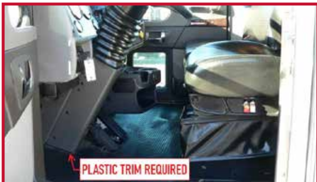
Figure 9 – Ajustement à la colonne de direction
