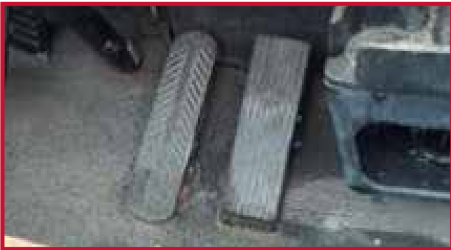
Figure 2 – Pédale d'accélérateur montée au plancher
