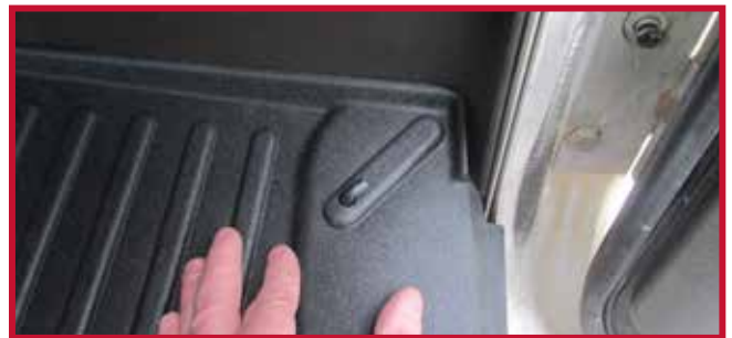
Figure 17 – Crochet de tapis côté passager installé
