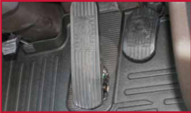
Figure 2 – Pédale d'accélérateur montée au plancher
