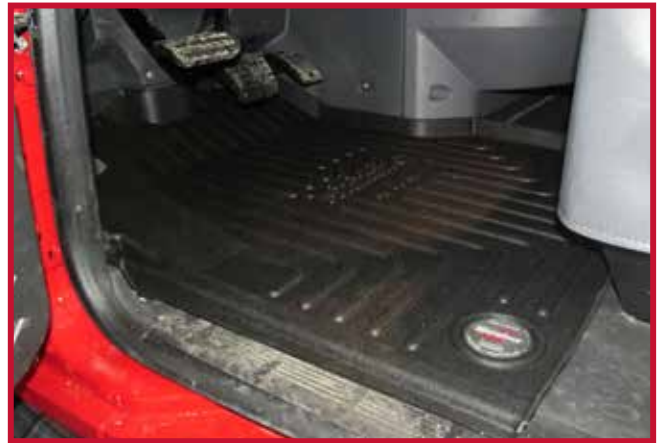
Figure 3 – Tapis côté conducteur en place
