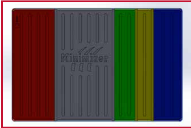
Figure 6 – Schéma de découpage du tapis central
