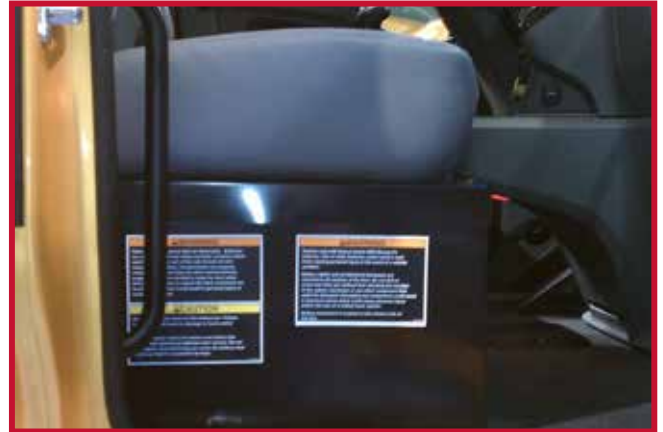
Figure 4 – Siège de passager avec rangement pour batterie
