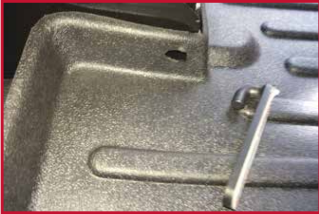
Figure 10 – Tapis côté conducteur avec trou pour crochet
