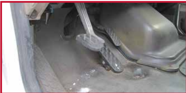
Figure 4 – Pédale d'accélérateur suspendue avec pédale de frein montée au plancher
