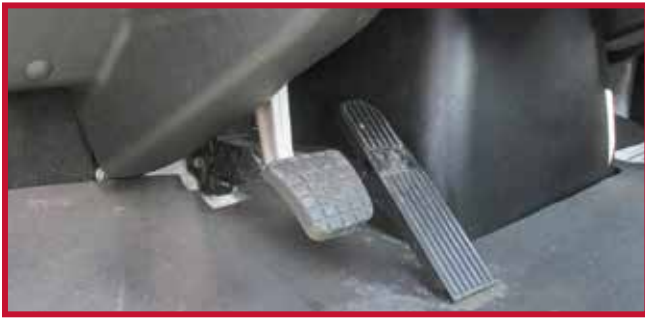
Figure 2 – Mécanisme de pédale d'accélérateur montée au plancher
