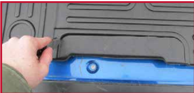
Figure 16 – Découpage à la main pour siège avec soufflet en caoutchouc
