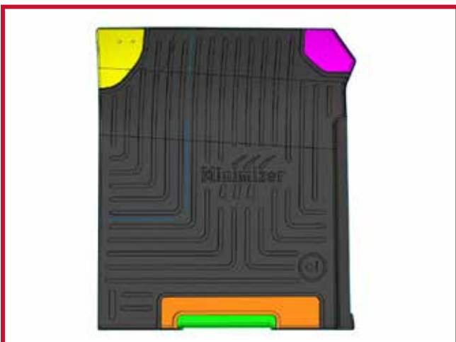
Figure 21 – Schéma de découpage du tapis côté passager
