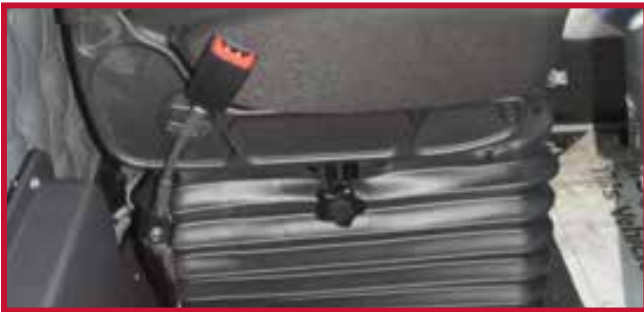
Figure 16 – Découpage à la main pour siège avec soufflet en caoutchouc
