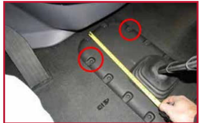
Figura 9 - Ubicación del gancho de retención
