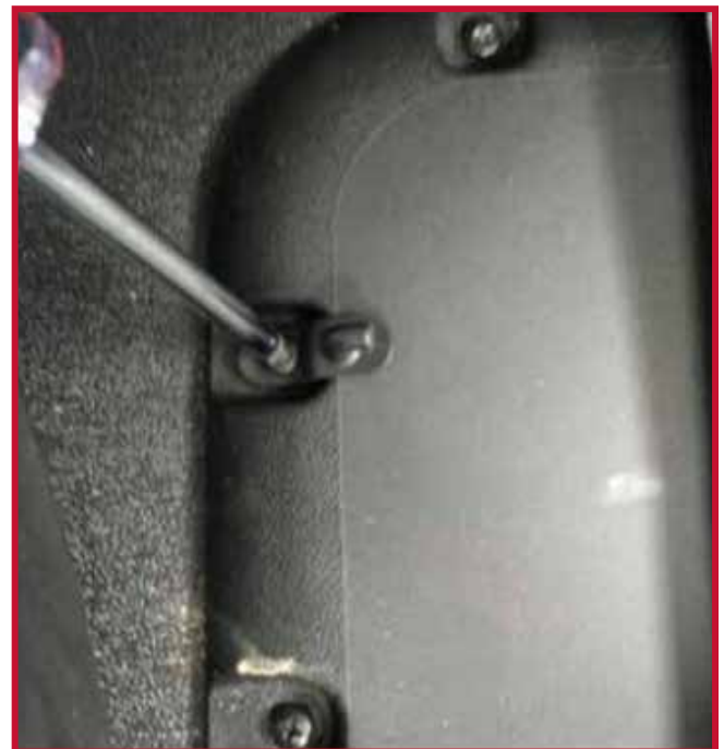
Figura 10 - Instalación del gancho de retención
