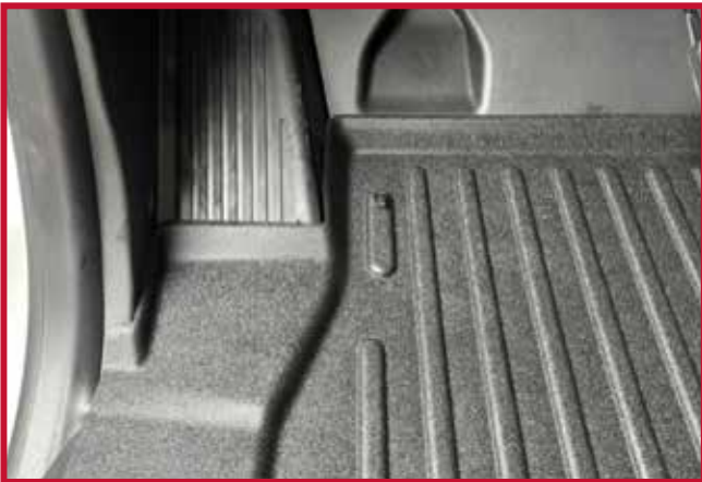
Figura 12 - Ubicación del gancho de retención del lado del conductor
