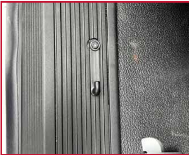
Figure 5 – Orientation du crochet de retenue
