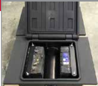
FIGURE 7 - TROUSSE DE FIXATION DE BATTERIES
