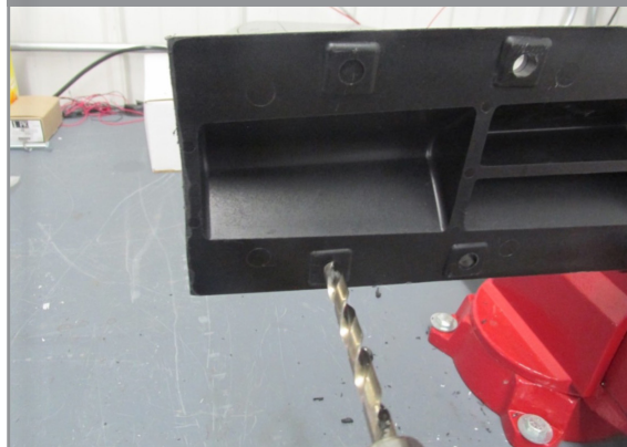
FIGURE 3 – PERÇAGE DU SUPPORT EN POLY APRÈS LA COUPE
