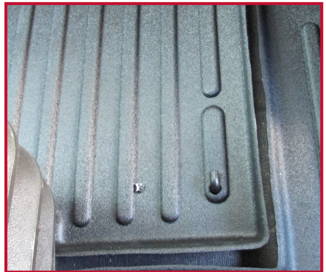
Figura 8 - Instalación del gancho del tapete del conductor
