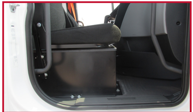
Figura 5 - Recorte del tapete central para la caja de la batería
