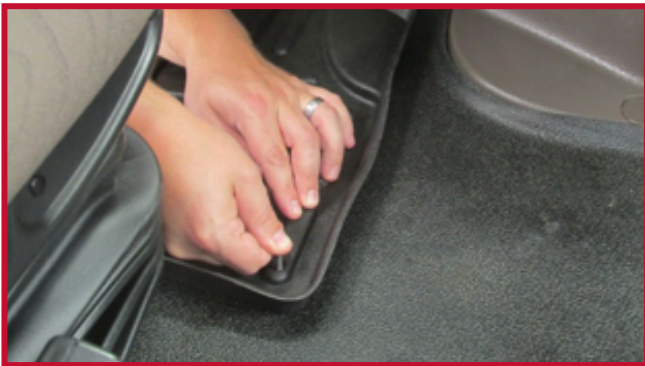
Figura 7 - Aplicar presión al gancho
