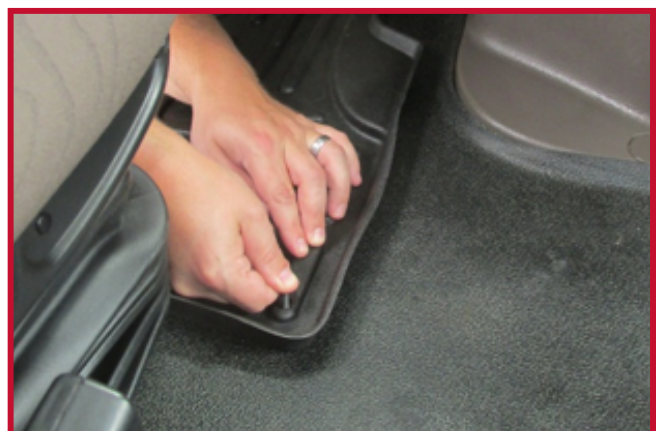
Figura 12 - Aplicar presión al gancho
