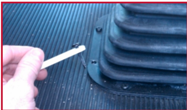
Figura 9 - Instalación del gancho en el tornillo existente
