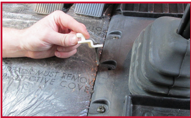
Figura 12 - Instalación del gancho
