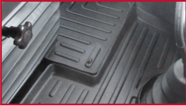
Figure 6 – Confirmer l'emplacement du tapis côté conducteur et crochet
