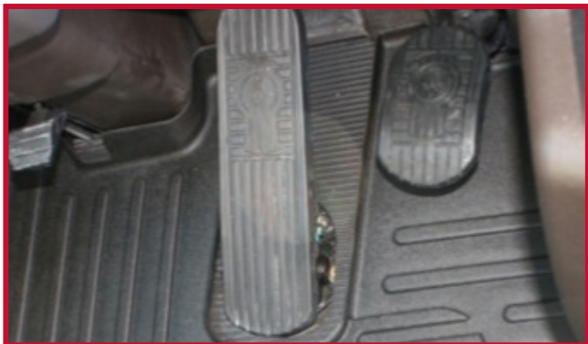
Figure 2 – Pédale d'accélérateur montée au plancher
