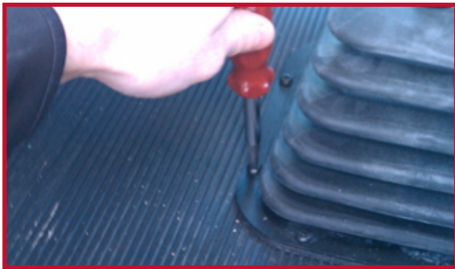
Figure 8 – Retirer la vis du soufflet du levier de vitesse
