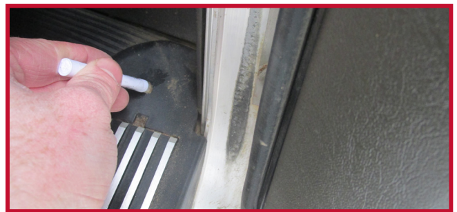
Figure 17 – Crochet de tapis côté passager installé
