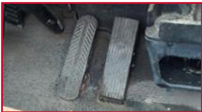
Figure 2 – Pédale d'accélérateur montée au plancher
