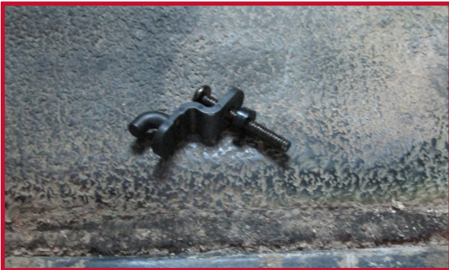
Figure 7 – Assemblage de crochet et d'espaceur
