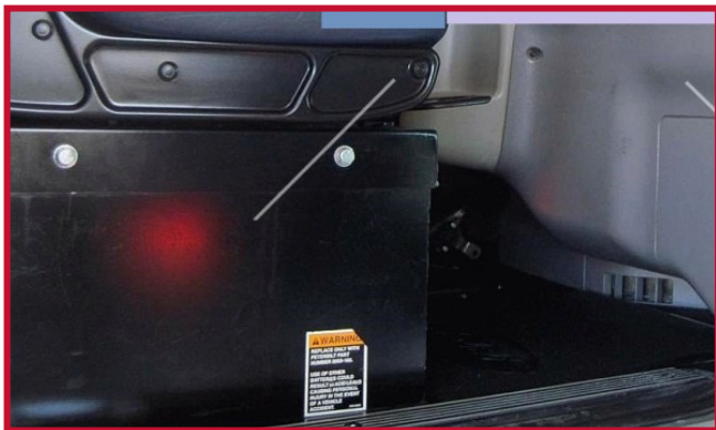
Figure 2 – Siège de passager avec rangement pour batterie
