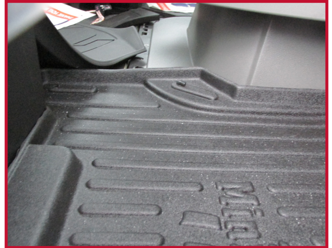
Figure 9 – Emplacement du crochet de retenue du tapis côté passager
