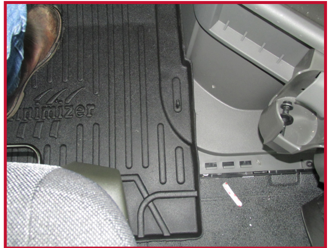
Figure 7 – Installation du crochet du tapis côté conducteur
